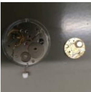
Mechanisches Uhrwerk und Quarz Uhrwerk
